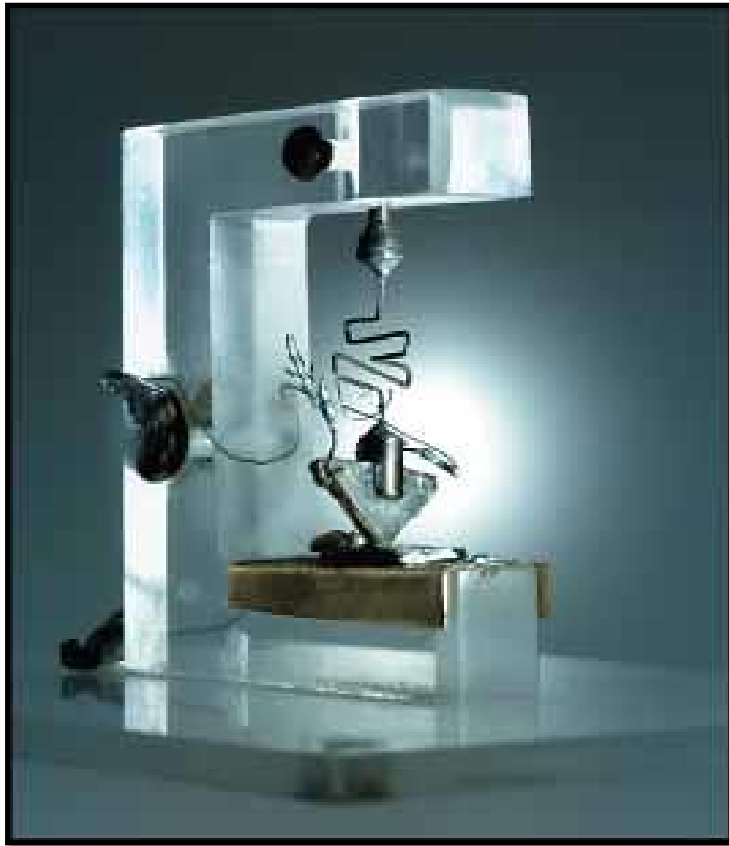
Современный макет точечного транзистора Бардина и Браттейна.
